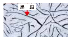
ハイカーボン鋳鉄 普通の鋳鉄より黒鉛の形状が大きい鋳鉄
